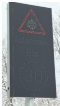
図7 自動運転バスの走行を検知すると制限速度を変更する表示盤
