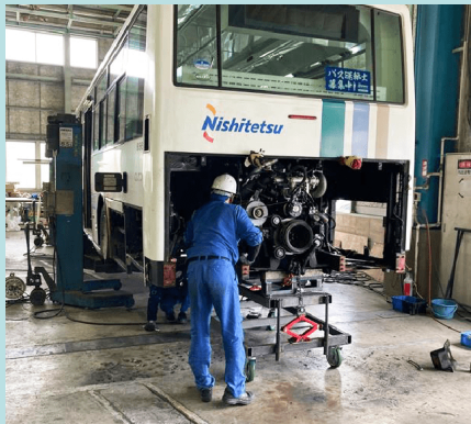
①エンジン・トランスミッション取り外し
