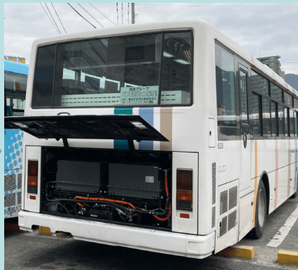
③バッテリーパックをエンジンルームに4台、車内に6台搭載
