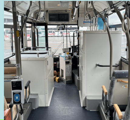
③バッテリーパックをエンジンルームに4台、車内に6台搭載
