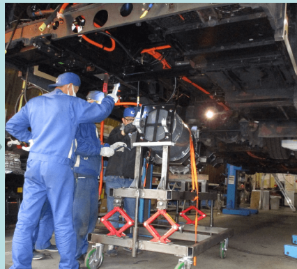
②モーター・バッテリー取り付け
