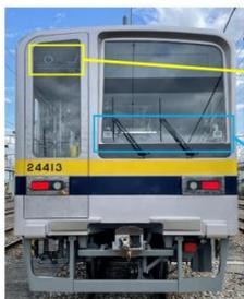
△前方障害物検知システム搭載車両（20400型）
