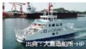
出典：大島造船所・HP フルバッテリー推進小型旅客船 「e-Oshima」
