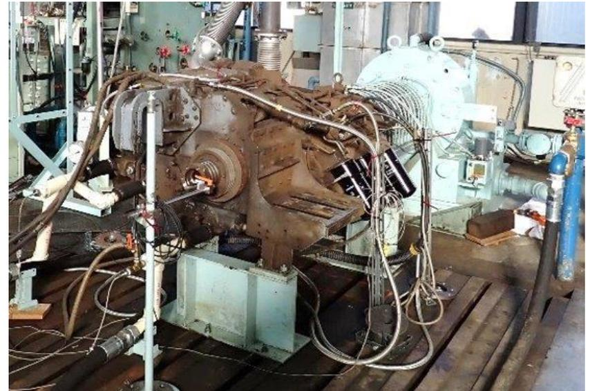
エンジン性能確認試験(写真提供:鉄道総研)
