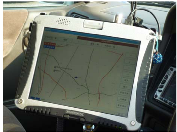
■運転席の車載器モニター画面 予約システムの通信機能により、 画面上に予約状況が表示される
