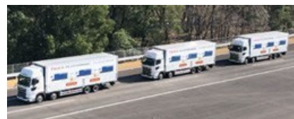
2020年3月 産業総合技術研究所テストコース (車速:30km/h, 車間距離:9m)
