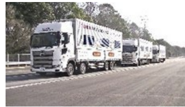
2020年11月 産業総合技術研究所テストコース (車速:80km/h, 車間距離:9m)
