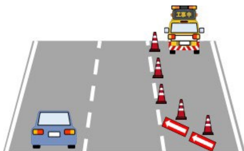
工事規制の位置、閉塞車線等
