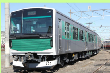
EV-E301系(2014) 蓄電池電車(ACCUM)
