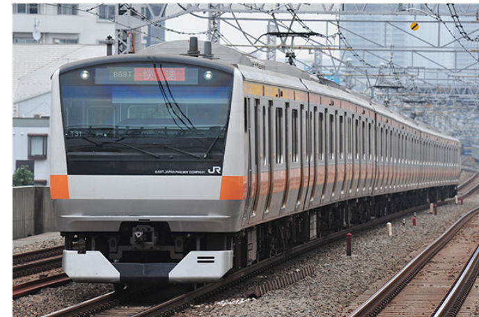
E233系 通勤・近郊での主力として活 躍するVVVFインバータ車両 (2006年12月～)
