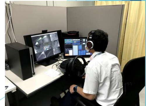
遠隔監視操作台
