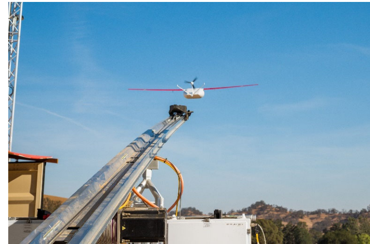
カタパルトを使用した機体の離陸 ©Zipline
