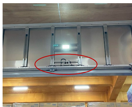
トラック荷室内の 3D センサー
