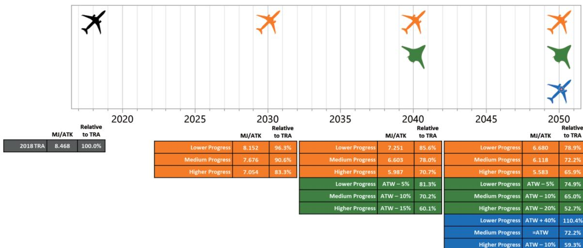
図 3-9 ATW ウェイポイント、ACA サービス開始時期と燃料消費原単位(WB の例)
