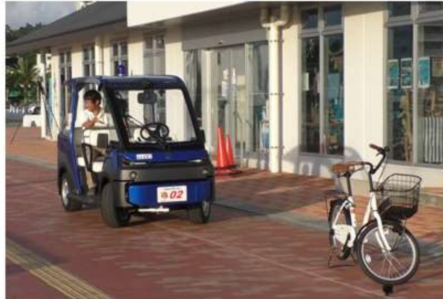
2. 遠隔操作卓から制御切替を行い、操舵を右に切った状態
