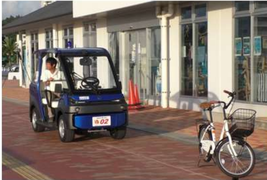
1. 電磁誘導線の自動走行中に自転車をセンサーで検知し停止
