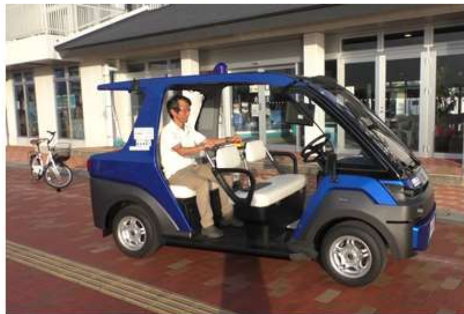
4. 自転車を回避し、電磁誘導線上の経路に戻り、遠隔操作から、自動走行へ切替
