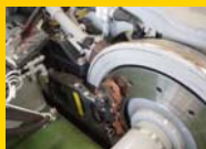
ブレーキ装置の性能向上 (高速対応ブレーキ装置)
