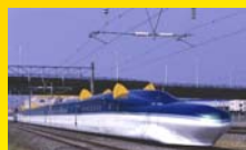
非常停止距離の短縮 (空気抵抗増加装置)
