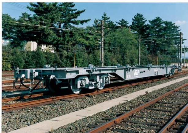
コキ106形式 コンテナ貨車 (荷重40.7トン 最高速度110km/h)
