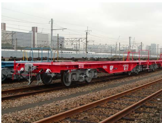
コキ200形式 コンテナ貨車 (荷重48.0トン 最高速度110km/h)
