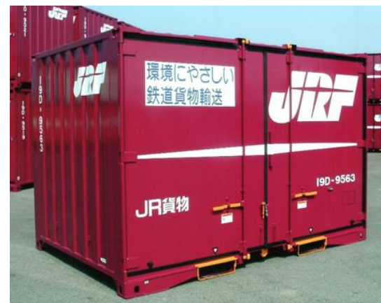
19D形式 12フィートコンテナ (両側開き・一般貨物輸送用)
