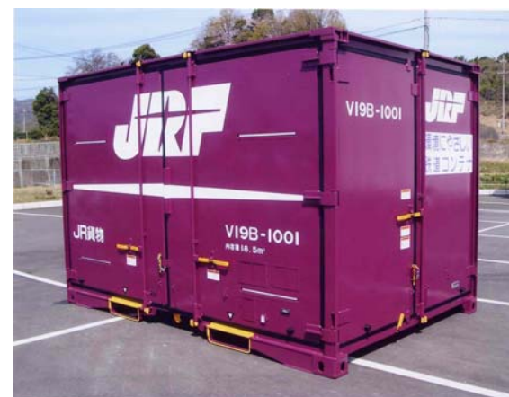
V19B形式 12フィート通風コンテナ (側妻二方開き)
