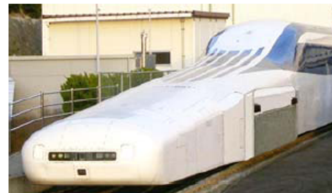
【Mc5先頭形状改良タイプ】 ・先頭部長さ: 15m(H21改造)
