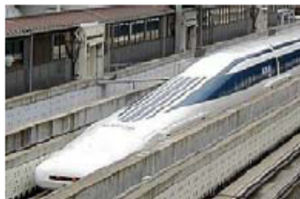
【Mc5】: H14製作 ・先頭部長さ: 23m ※試験的に最大限伸ばした形状
