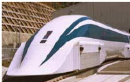
【Mc1】: H7製作 ・先頭部長さ: 9.1m ※第一編成車両
