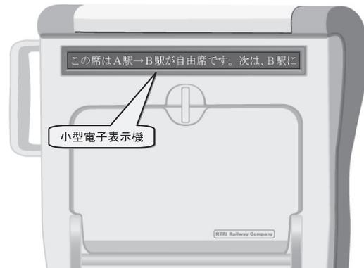
■図—17 座席背面の小型電子表示機による座席設定情報の提供(イメージ)
