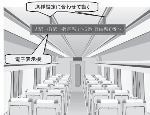
■図—16 車内の可動式電子表示機による座席設定情報の提供(イメージ)
