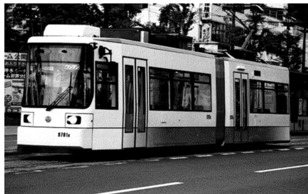
■図一1 日本初の低床ライトレール車両(熊本市交9700形)
