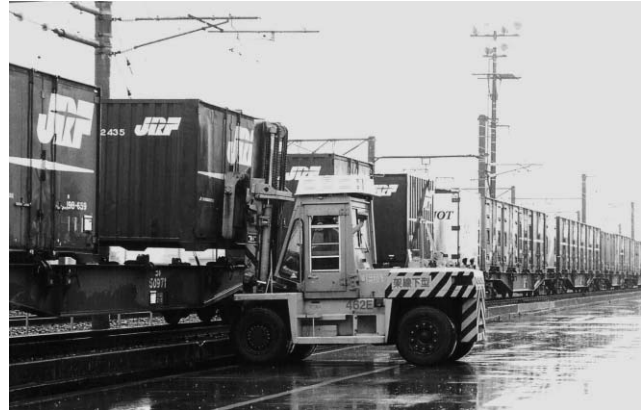
■写真-4 E&S駅における架線下での荷役作業
