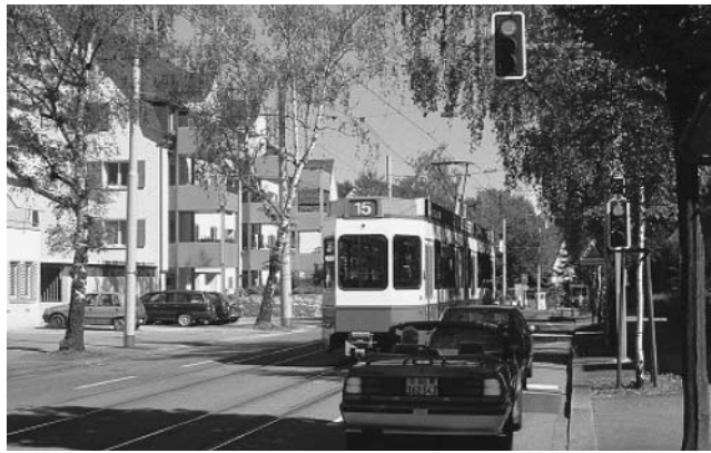
■写真—9 公共交通優先のためにトラム電停で車線数を減らしている例。トラムやバスの停車中は、手前の一般車両向けの信号が赤となる。【Laubiweg電停近辺にて撮影】
