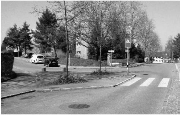
■写真—12 歩行者滞留スペースを多く取る代わりに横断歩道部の車線を減少させ、横断距離を短縮させている 【Lerchenrainにて撮影】
