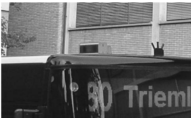
■写真一16 バスに取り付けられた赤外線送受信器【Oerlikon Nordにて撮影】
