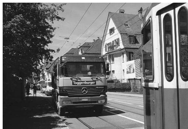
■写真—5 トラム後方の交通渋滞。追越車線がないためにトラム電停で停止の度に行列が発生する【Schwert電停にて撮影】
