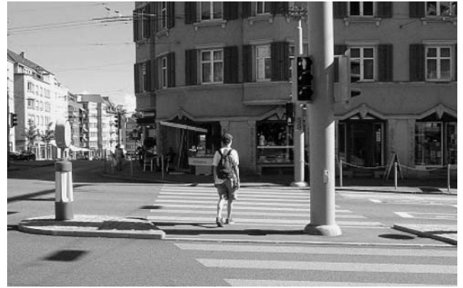
■写真—13 市内には二段渡しの横断歩道がいたるところに見られる【Schaffhausenplatz付近で撮影】
