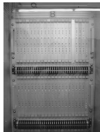
■写真—14 市警察の中央情報センターで信号制御を行う大型計算機の1つ。6台の大型計算機が稼働している。
