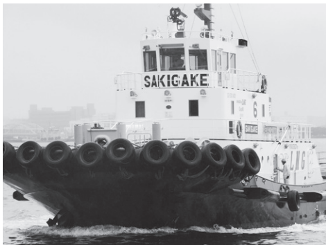
■写真—3 我が国初のLNG燃料船タグボート「魁」
