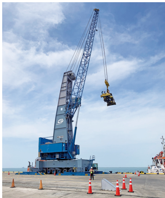
図7 モバイルハーバークレーン（2026年筆者撮影）
