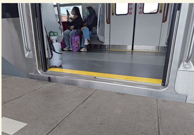
写真11 中国中車製車両のホームとの段差。写真9や10と比べて小さくなっていることがわかる
