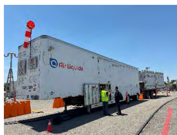
移動式水素燃料供給装置
