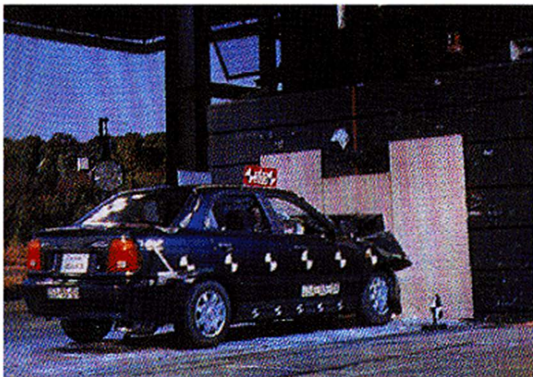
正面衝突試験の実施状況
