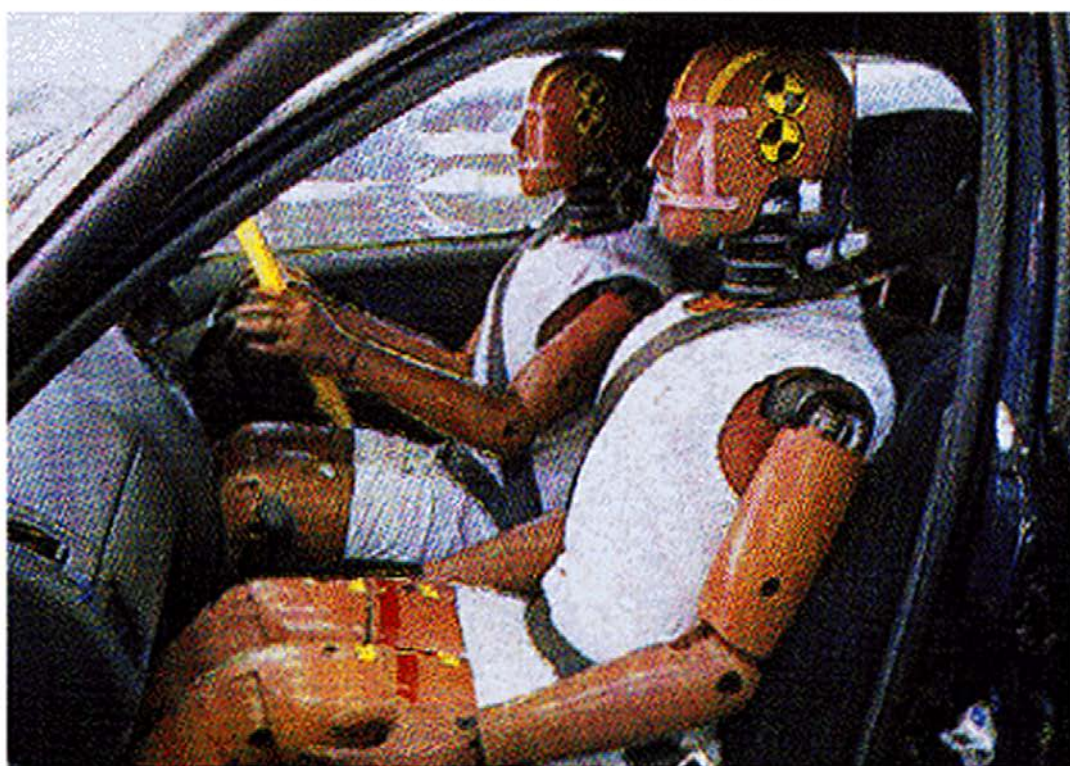
衝突時の衝撃を測定するダミー (人体模型)
