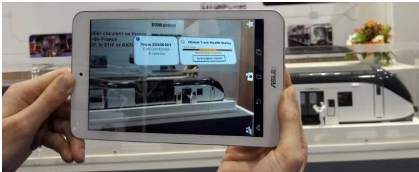
拡張現実を用いたメンテナンス状況の確認※
