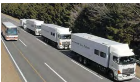
(2) 日本自動車研究所による自動隊列走行@つくば市 トラック 4台：80km/h + 4m
