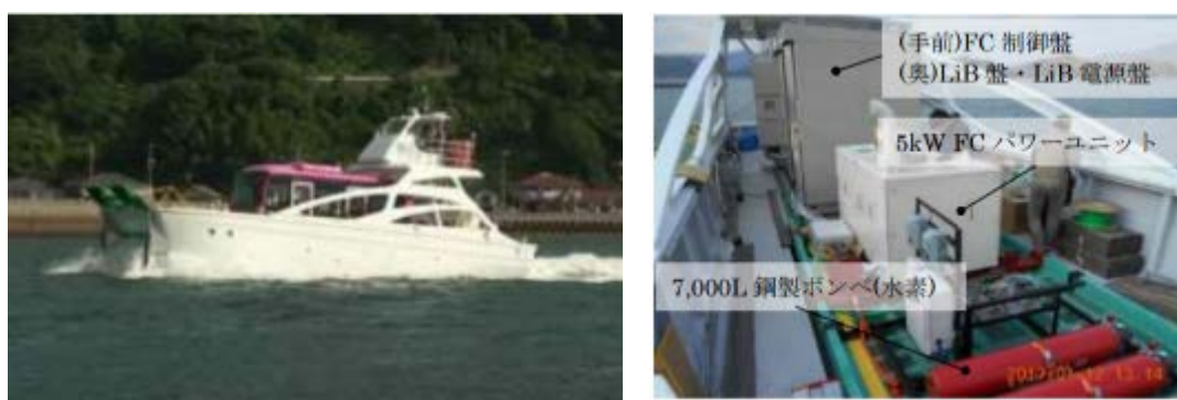
図 5-2 神峰の外観(左)および甲板に搭載された燃料電池システム(右)
