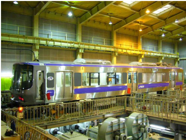
高速車両試験台での 走行模擬試験
