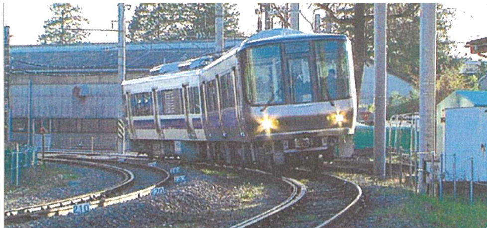
図 鉄道技術総合研究所開発の燃料電池ハイブリッド試験車両
