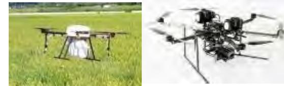
複数の小径ローターを回転方向を上手く組み合わせることで、シングルロータータイプと同様の動きを実現したタイプ。コンピュータ制御のサポートを受けることで驚くほどの安定感を持ち、今後の産業用UAVの主流となりつつある。
