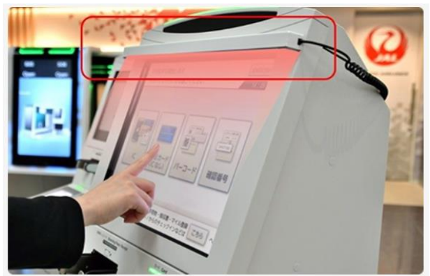
空港チェックイン機・自動手荷物預け機 タッチパネルの非接触化
